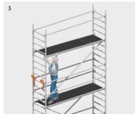
Diagonalen und Durchstiegsbrücke einsetzen.
